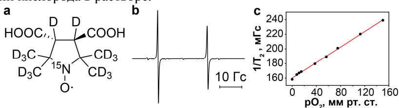
Рисунок 1. Структура (а) и спектр ЭПР (б) радикала ^2H, ^{15}N -ДКП. (с) Зависимость лоренцевой составляющей ширины линии спектра ЭПР от парциального давления кислорода.
