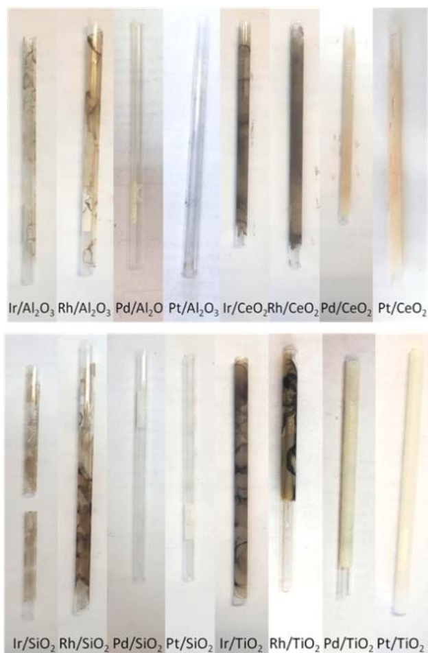
Рисунок 29. Фотографии реакторов с каталитическими покрытиями (16 составов) после гетерогенного каталитического гидрирования 1,3-бутадиена.
