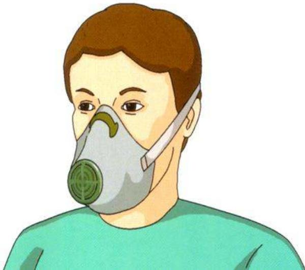
Для защиты органов дыхания можно использовать респираторы - облегченное средство защиты органов дыхания от вредных паров, газов, аэрозолей и пыли. Они широко применяются на химических и металлургических предприятиях. Состоят они в основном из резиновой полумаски и пористого фильтра (двух фильтрующих секций из бумажных, матерчатых, фетровых, ватных материалов).
