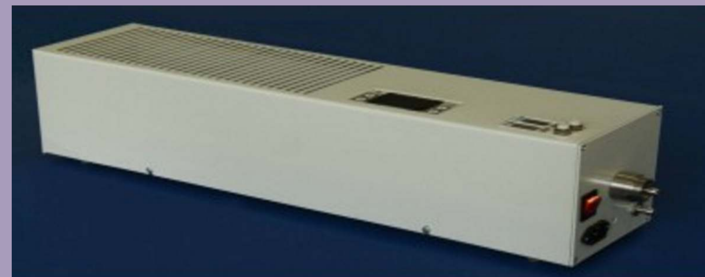
Термоконденсационный генератор наноразмерного аэрозоля. Концентрация 10 5 -10 8 см -3
