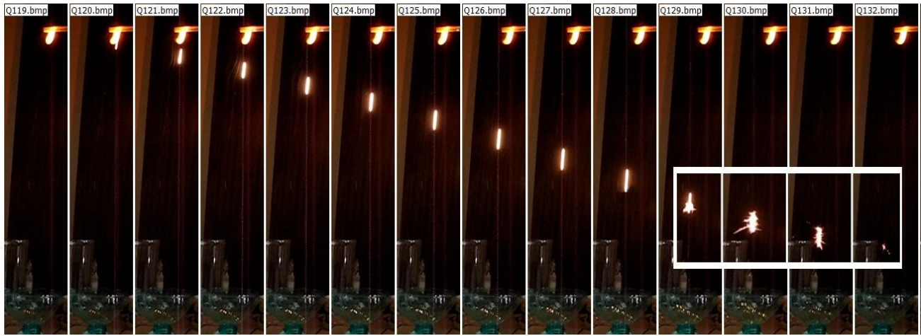
Рисунок 3 – Кадры видеозаписи процесса горения частицы-агломерата в свободном падении в воздухе. Вверху виден образец, испускающий горящий агломерат. Светящиеся отрезки соответствуют расстоянию (около 5 см), которое проходит горящая частица за время экспозиции кадра 1/25 с. Рамкой помечены события начало фрагментации, окончание фрагментации и окончание горения частицы
